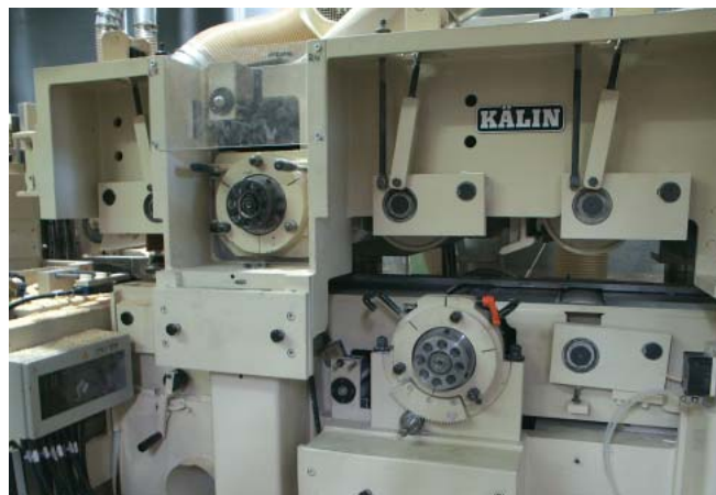
Hochleistungshobelmaschine arbeitet mit Vorschüben von 10 bis 120 m/min
