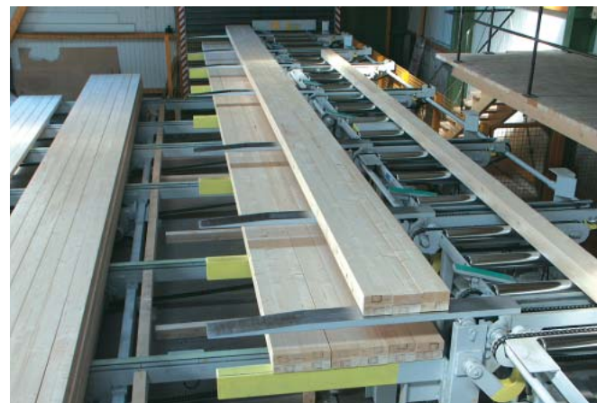
Transport-Rollen und Stapelgabeln bei der Abstapelung sind verchromt, um das Holz vor Verschmutzung zu schützen
