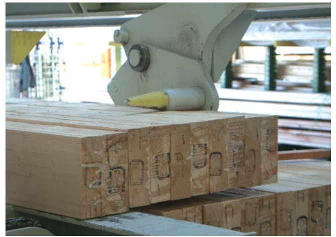
Drei Stapel sind im Puffer der Beschickung, der vierte befindet sich am Hubtisch von dem Lage für Lage abgeschoben wird
