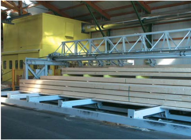
Beschickung der bis zu 16 m langen Duo-Balken und KVH-Stangen FOTOS: SCHNEIDER
