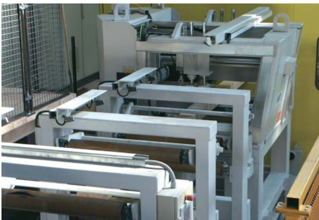
Platzsparende Einheit mit fünf verfahrbaren Achsen: Auf nur 9 m wird fliegend gesägt und foliert
