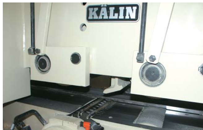
Hobelmaschine besitzt 6 Hobelwellen mit Durchmesser von 250 mm, sie werden komplett als Einheit mit Lagerungs-System gewechselt
