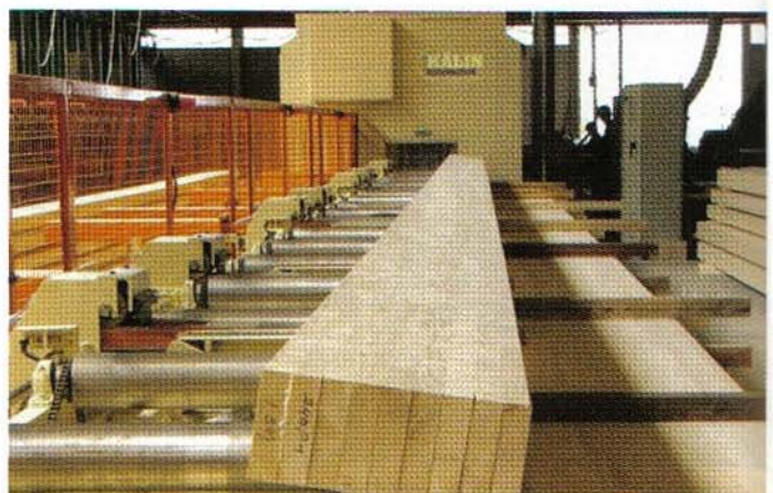
Kantenschonender Abtransport parallel zu Auslaufrollen
