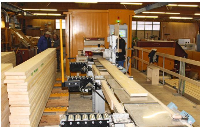
**Rollenbahn von Matec vor dem Einlauf in die Hobelmaschine:** Lamellen bis 16 m Länge können bearbeitet werden
