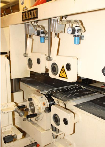
**Die Hobelmaschine** verfügt über Wellen mit 220 mm Durchmesser
