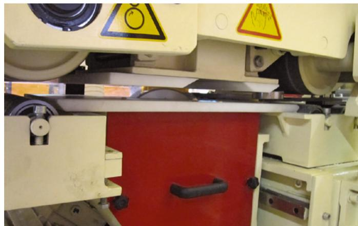
**Kälin Hobeltechnik lieferte die neue Hobelmaschine** – eine „frisierte“ Compact-Anlage mit 80 m/min Vorschub und Trennschnitt-Aggregat
