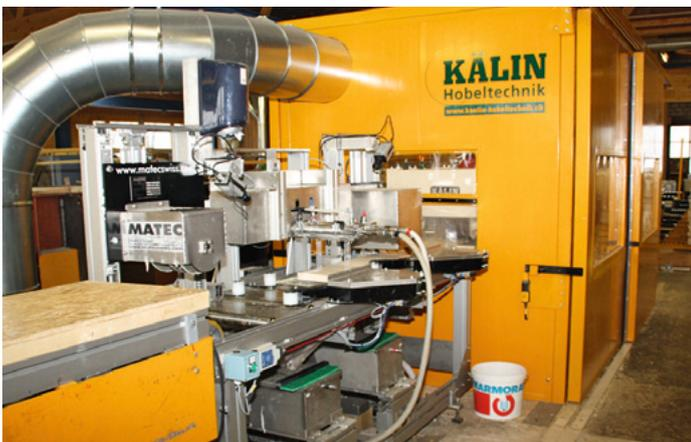
**Leimauftragsmaschine von Matic** ist direkt hinter der Hobelmaschine in die Linie eingebaut
