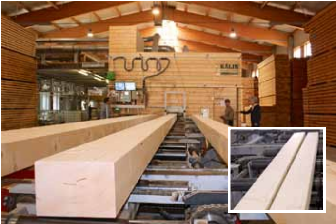
Bis 19,5 m lange Balken erzeugt Eschelmüller , die eingehaute Hobelmaschine schafft starke Querschnitte und trennt auch auf – inklusive Fase (kl. Bild)
