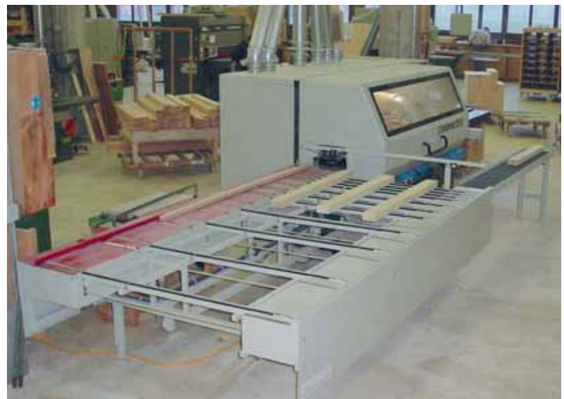
Das eigengebaute Quer-Rückförder-System «Näf», das vor allem im Massivholzbereich eingesetzt wird. Diese Art Maschine wird individuell den Kundenwünschen angepasst und wird zu 100 Prozent bei der Näf Service und Maschinen AG in Herisau hergestellt.
