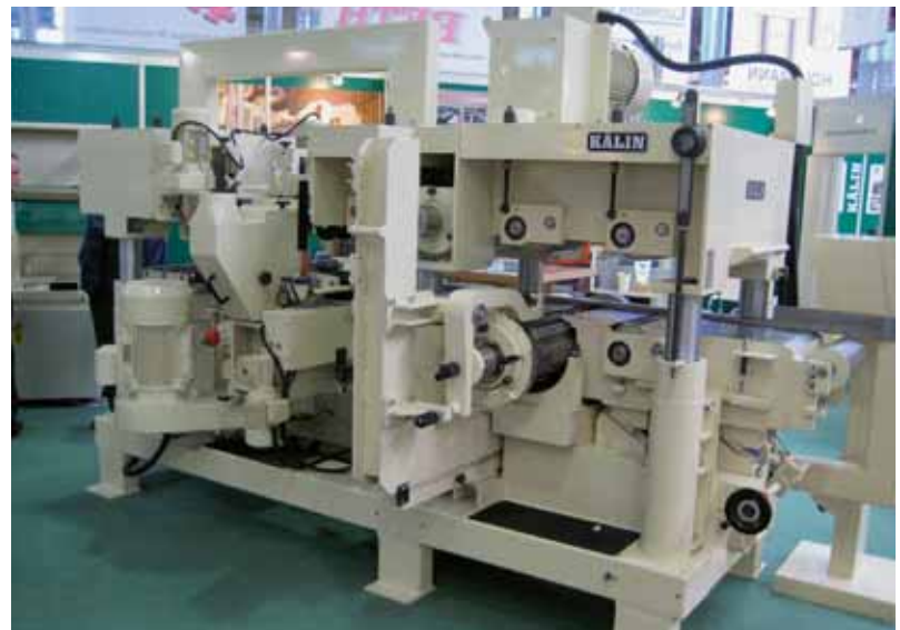
Hochleistungsmaschine «Compact-NG» von «Kälin Hobeltechnik» (erhältlich bei der Näf Service und Maschinen AG in Herisau): für das industrielle Hobeln von Lamellen, KVH usw.; ausgelegt für Vorschub-Geschwindigkeiten bis 100 m/min.
