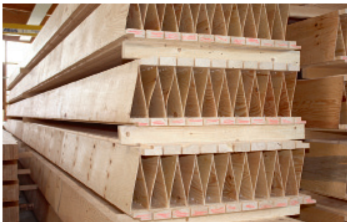
Fertige Kielsteg-Elemente: bisher produzierte und verbaute Kulmer über 7000 m 2 in zehn Pilotprojekten
