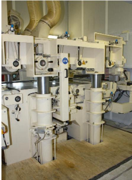
**Zwei der insgesamt sechs Hubzylinder**, die den Oberteil der Maschine kraftvoll anheben
