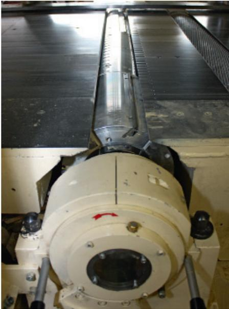
**Horizontalwellen** mit 1,25 m Breite sind oszillierend ausgeführt
