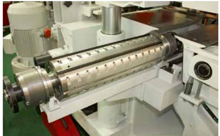
**Hobelwellen der Timberwork** können auf Wunsch als Wechselwellen ausgeführt werden
