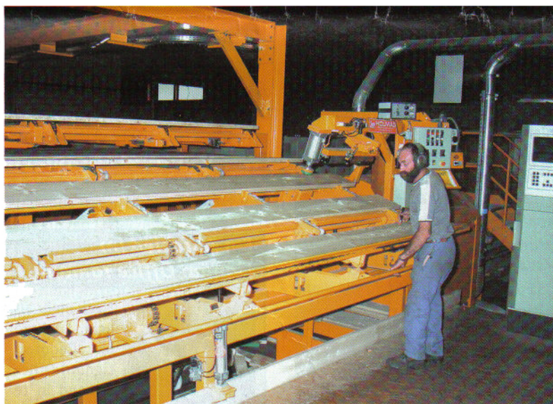
Der einzige Mann an der Fertigungsanlage – neben der Gesamtüberwachung sortiert er und bezeichnet die Kappstellen der einlaufenden Bretter.
