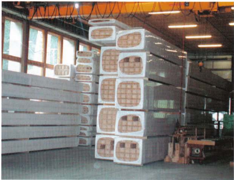
Das Endprodukt: «Lignatur»-Systembauteile vor dem Abtransport zur Baustelle. Foto: Gottfried Meier
