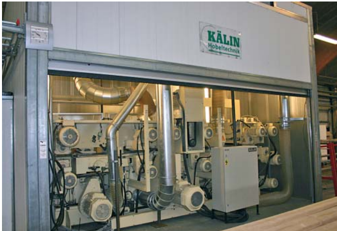
ANZAHL Hobelwellen sorgen für eine schöne Oberflächen-Qualität der Lamellen
