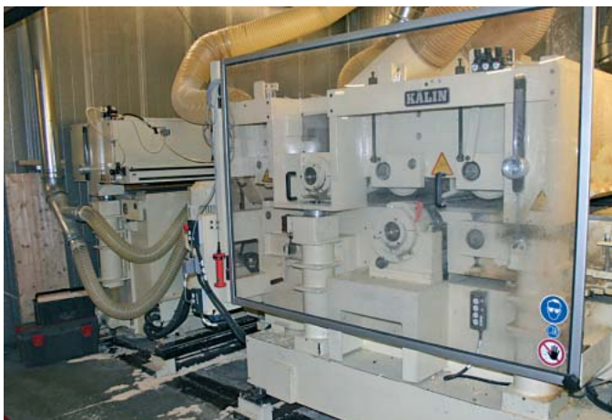
Kälin-Finalhobelmaschine: hier bekommen die Binder den letzten „Schliff“ (inklusive Fase)
