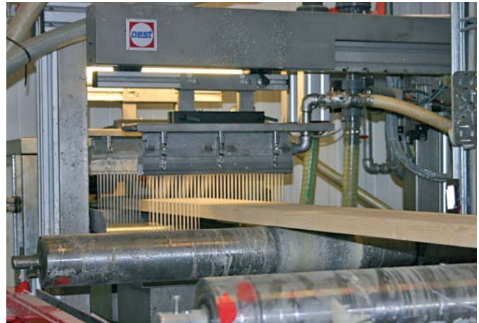
Unmittelbar hinter der Kälin-Lamellenhobelmaschine befindet sich der Leimauftrag von Oest
