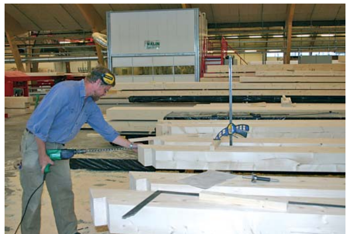
Abbund für Objektaufträge wird bei Lilleheden noch per Hand durchgeführt
