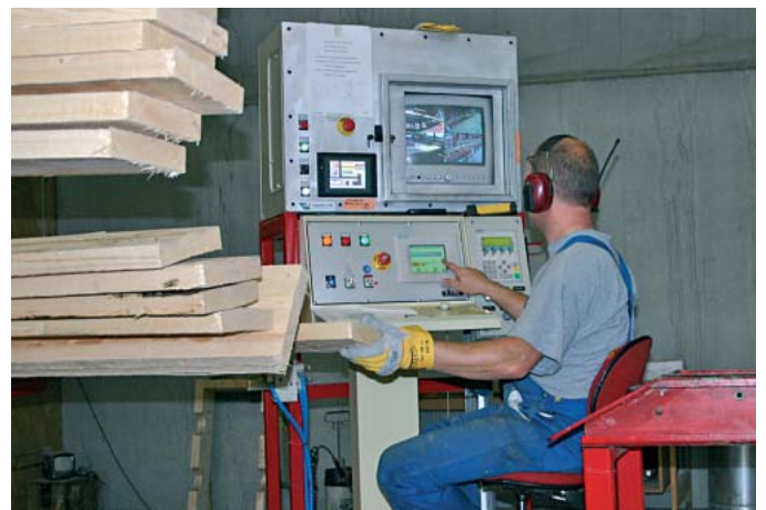
Einzug in die Lamellenhobel-Maschine von Kälin – der Bediener legt die keilzinkte Ware händisch ein
