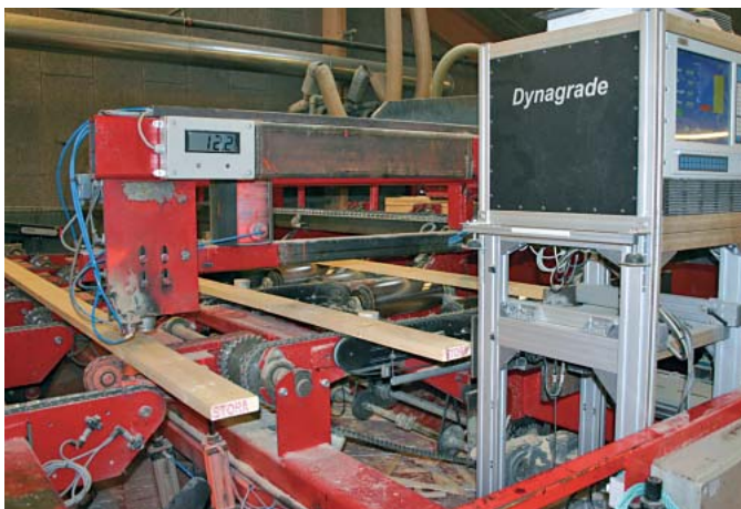
Lamellen werden entstapelt, nach Festigkeit und visuell sortiert und in vier Klassen eingeteilt
