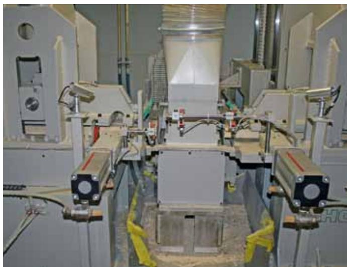
**Flyback-Keilzinkenautomat** von Howial wurde eigens für Stuber & Cie entwickelt
