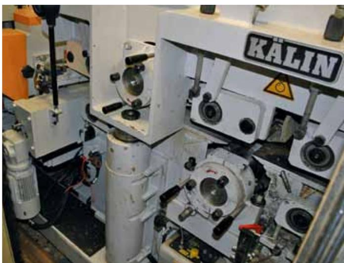
Lamellenhobelmaschine von Kälin wurde eigens auf die beengten Platzverhältnisse hin konzipiert
