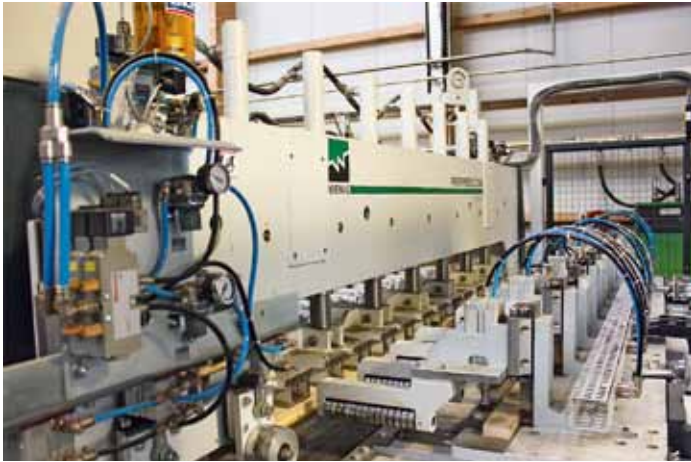
Die Profipress C 2500 von Dimter wird mit den PU-beleimten Lamellen automatisch beschickt
