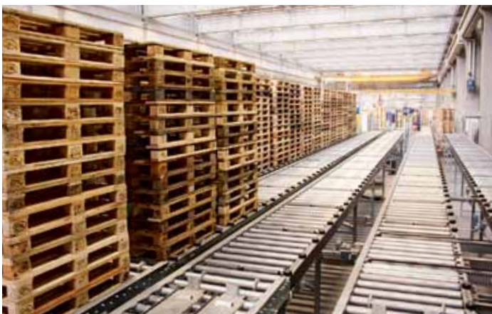
Start der 100 m langen Produktionslinie: Auf den Rollenbahnen werden sowohl die Paletten als auch das Schnittholz bereitgestellt
