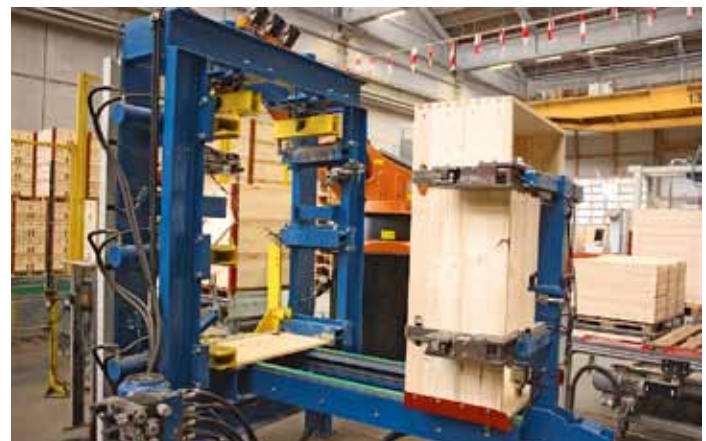
Wie von Zauberhand: Zwei Roboter setzen die Einzelteile vollautomatisch zu fertigen Aufsteckrahmen zusammen
