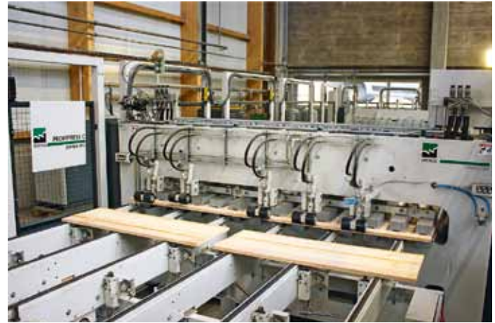
Nach der Verleimung in nur sechs Minuten kommen die fertigen Seitenteile auf der anderen Seite heraus
