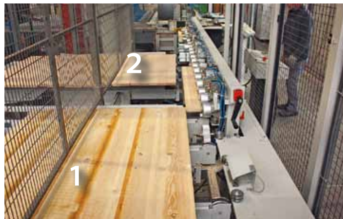
Zwei Zuführungen gibt es für die getrockneten und gehobelten Lamellen: vorne für Fichte (1), hinten für Buche (2)
