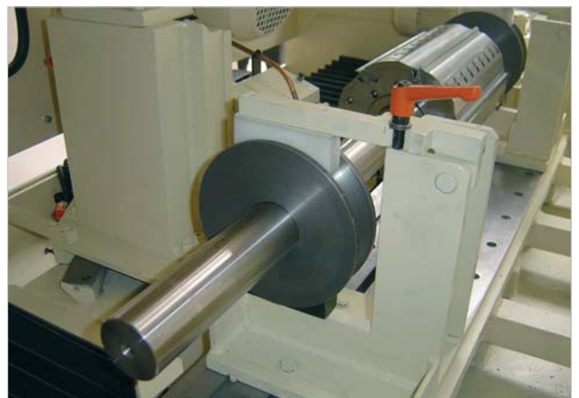
Hobelwelle, 670 mm, komplett mit Lagerungs-System und Steckkupplung in Schärffposition.
