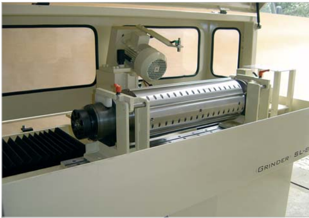
Hobelwelle, 670 mm, komplett mit Lagerungs-System und Steckkupplung in Schärffposition.
