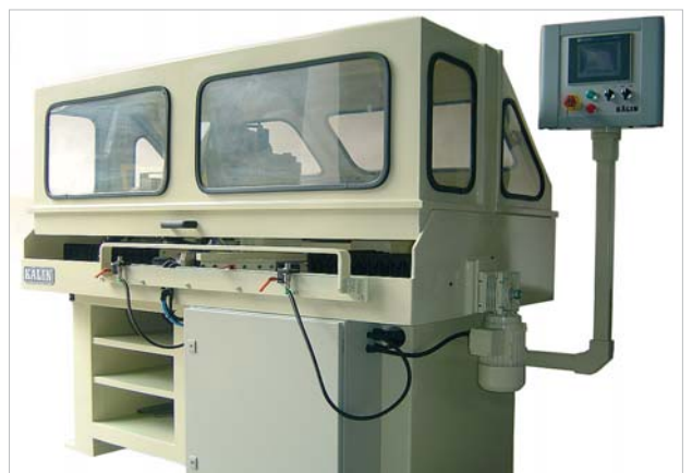
Umsetzbare Näherungsschalter zur Begrenzung des Fahrweges je nach Arbeitsbreite.
