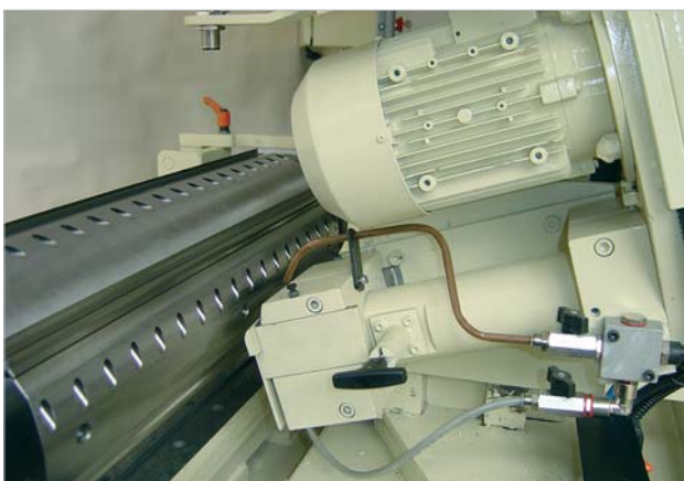
Innen und aussen gekühlte Schleifscheibe für hohe Leistung.
